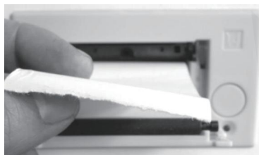
Fig. 6-11 Posizionare la copertina posteriore in carta sopra la copertina anteriore.
