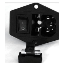
Fig. 6.7 Sostituzione del fusibile
