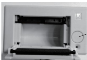
Fig. 6-9 Apertura del coperchio anteriore della stampante
